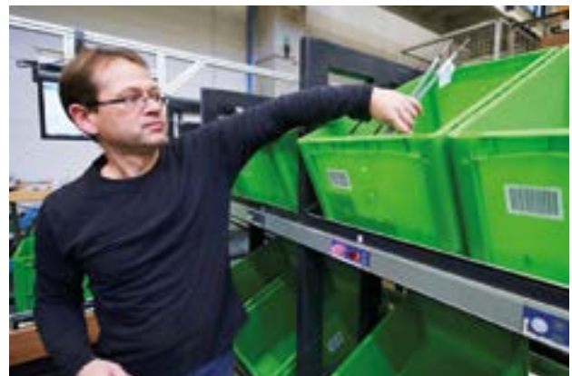
Kommissionierung mittels Pick-by-Light
